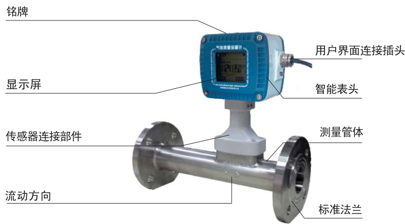
（图3-1）MF-FD系列管道式流量计结构图
