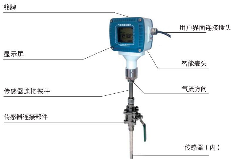
（图3-2）MFI系列插入式流量计结构图
