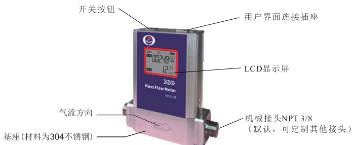
(图3-1) 微机电气体质量流量计结构图
