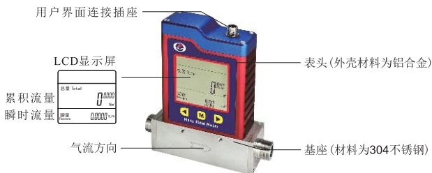
(图3-1) 微机电气体质量流量计结构图
