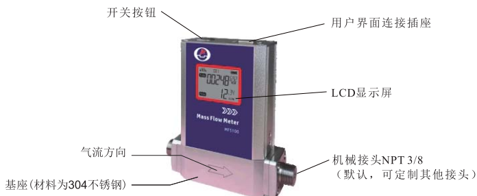
(图3-1) 微机电气体质量流量计结构图
