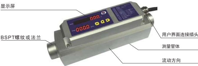
(图3-1) 流量计结构图
