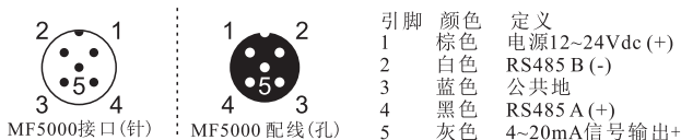
(图6-1) 用户接口M12(针)与配线M12(孔)引脚及颜色定义
