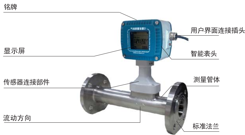
（图3-1）MF-FD系列管道式流量计结构图
