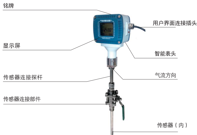
（图3-2）MFI系列插入式流量计结构图
