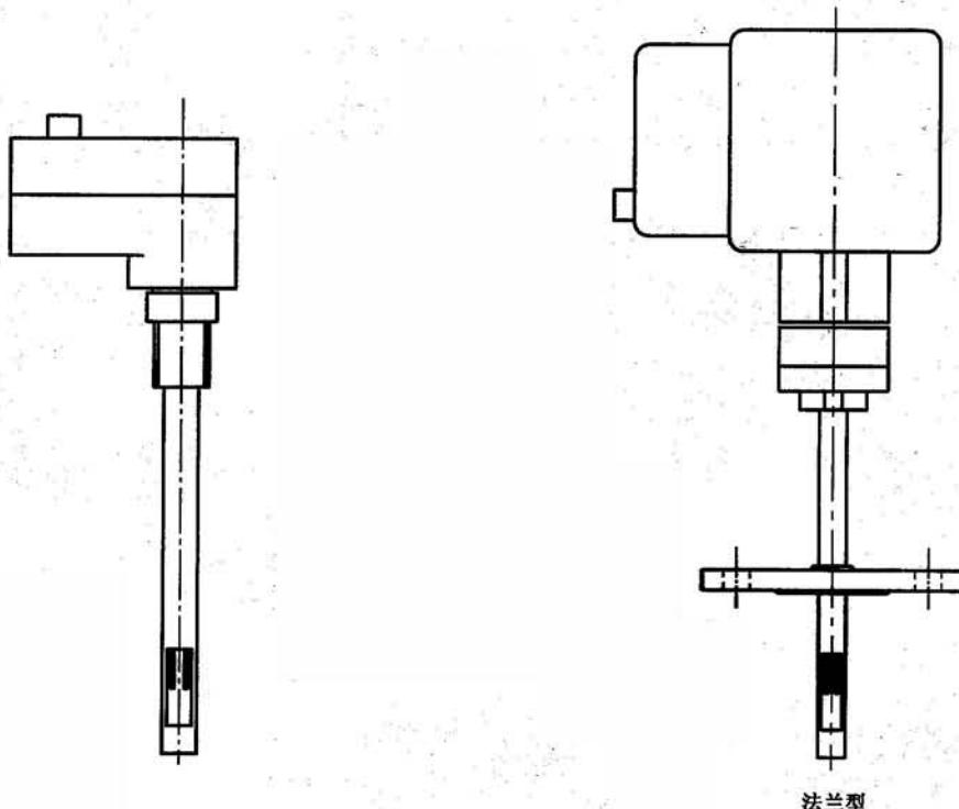
图 7 典型的插入式 ITMF 流量计结构
