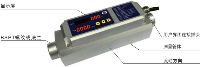
(图3-1) 流量计结构图
