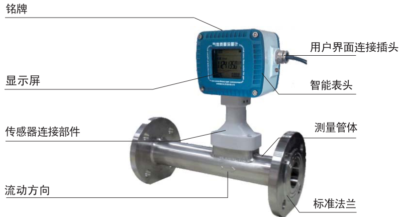
(图3-1) MF-FD系列管道式流量计结构图
