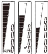
开机后，流量计会自动进入正常工作模式。正常工作模式有三种显示界面，短按功能键（0.5秒以内）可以在不同界面之间切换，详细如左图。
