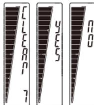
在“清除用气时间 (Clear T)”界面下，长按功能键（1s以上）进入“YES”和“NO”选项，短按功能键（0.5s以内）可在“YES”和“NO”选项之间切换。选定“YES”后，长按功能键（1s以上），用气时间将会被清除，然后自动回到“清除用气时间 (Clear T)”界面。
