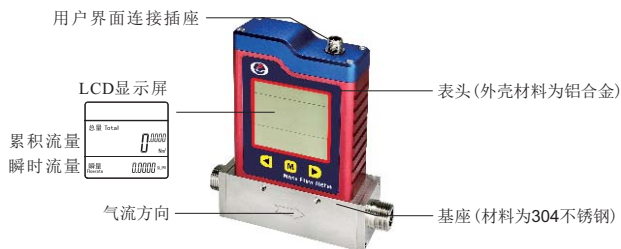
(图3-1) 微机电气体质量流量计结构图
