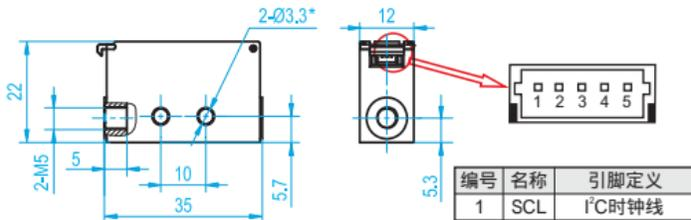
\* M3螺钉安装力矩:  $0.25 \pm 0.03 \text{ N} \cdot \text{m}$
